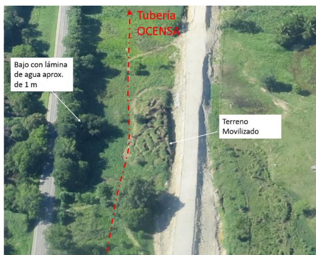
Caso PK 336+300 levantamiento por construcción de terraplén vial paralelo al derecho de vía. 4
