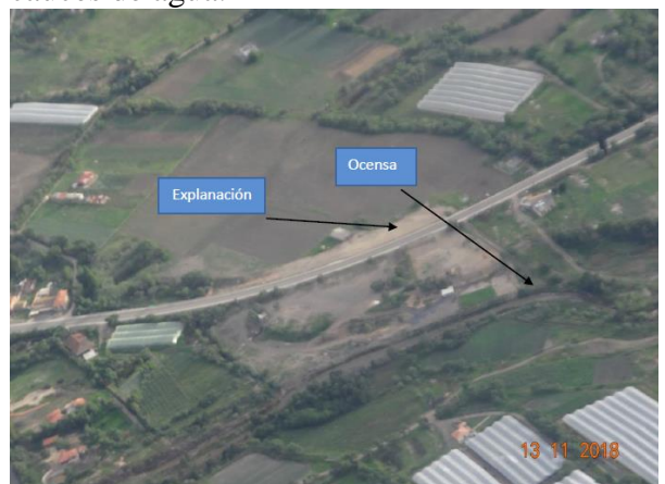
PK 152+250 explanación y rayón a la tubería con maquinaria pesada. Fuente OCENSA.
