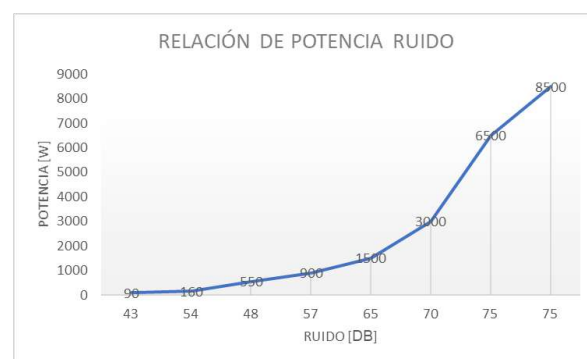
Figura 2. Ruido en Bombas de paletas rotativas selladas con aceite, Atlas Copco [14]
