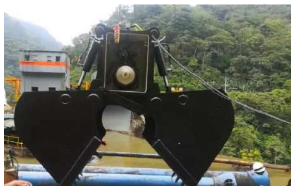
Figura 5. Mordazas (almeja) a instalar en estructura metálica.
