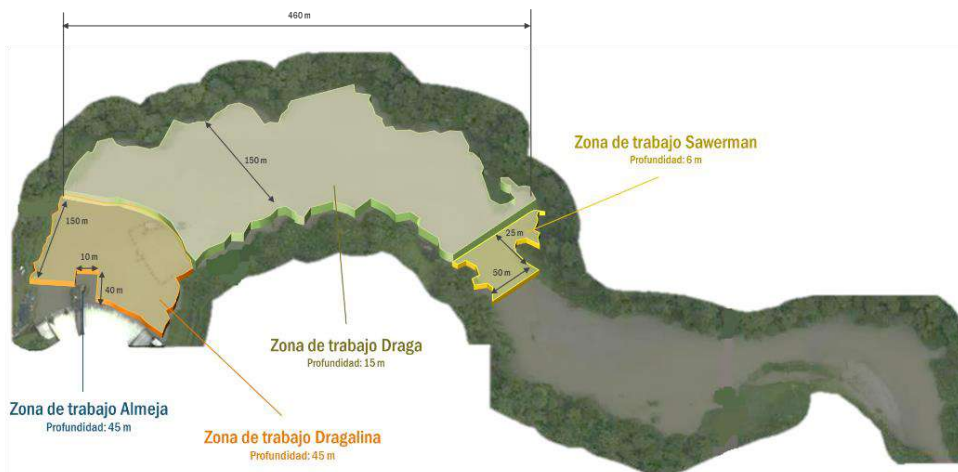
Figura 6. Distribución de equipos electromecánicos para el tránsito de sedimentos en el embalse
